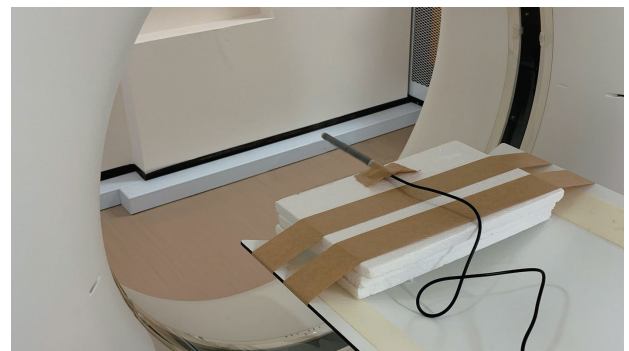
図13 円筒形ファントムを用いないCT線量指数（CTDI free air ）の測定
